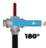
Position de la poignée à 180° : les deux entrées sont déconnectées de la sortie Handle position at 180°: both inputs are disconnected from the output
